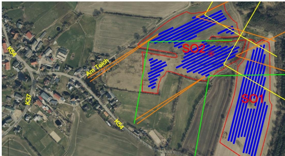
Abbildung 16: Bodennahen Reflexionsrichtungen des Gebiets SO2 bei Südausrichtung der Trackersysteme durch gelbe (5° Neigung), orangene (17°) und grüne (70°) Winkel mit 300 m Schenkellänge, angetragen an ausgewählte Eckpunkte
