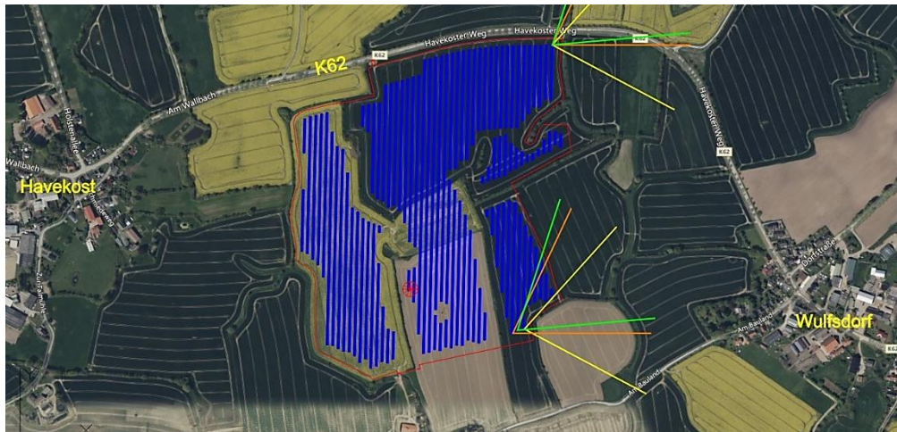
Abbildung 13: Bodennahe Reflexionsrichtungen bei Ostausrichtung der Trackersysteme durch gelbe (5° Neigung), orangene (17°) und grüne (70°) Winkel mit 300 m Schenkellänge, angetragen an ausgewählte Eckpunkte
