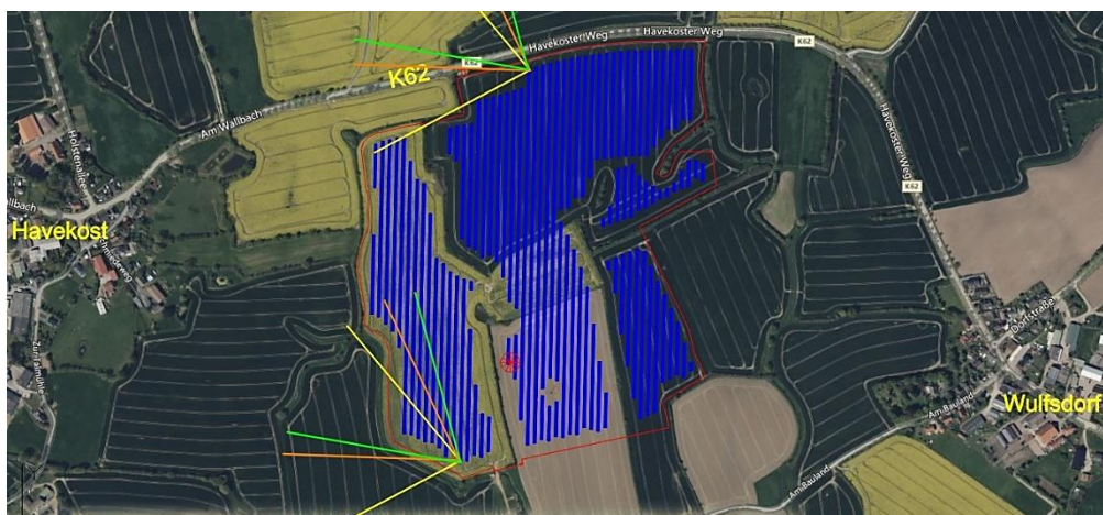
Abbildung 14: Bodennahe Reflexionsrichtungen bei Westausrichtung der Trackersysteme durch gelbe (5° Neigung), orangene (17°) und grüne (70°) Winkel mit 300 m Schenkellänge, angetragen an ausgewählte Eckpunkte
