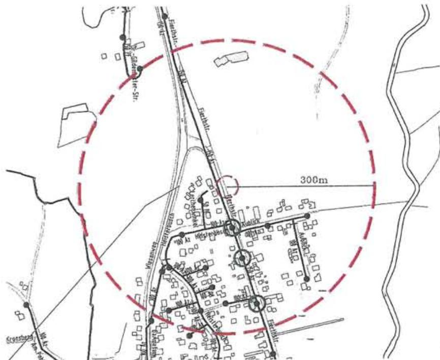
Abbildung 9 - Anlage Planausschnitt Wasserrohrnetz ZVO, mit Markierung der betr. Objekte und der möglichen Hydranten
