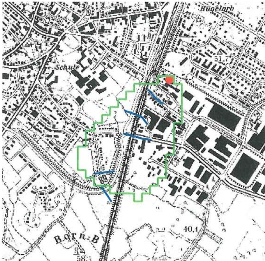
**Bild 3:** *Umrise der Geruchsfahne (grün) bei Ansatz einer diffusen Geruchsemission von  $40 \cdot 10^6$  GE/h Ausbreitungsklasse III, Windgeschwindigkeitsklasse 6 (Die Achsen der Fahnenbegehung sind blau gekennzeichnet)*
