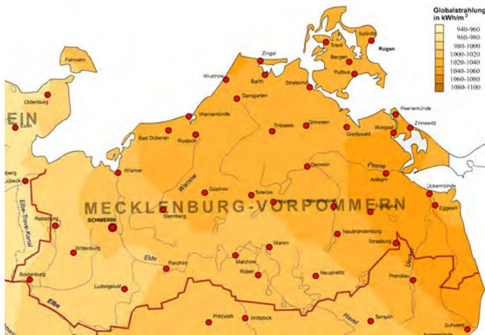
Abb. 29: Globalstrahlung in Mecklenburg-Vorpommern im Jahresmittel (1981-2000), mittlere Jahressummen in kWh/m<sup>2</sup> ; Quelle: EWS, 2016: Globalstrahlung in Norddeutschland
