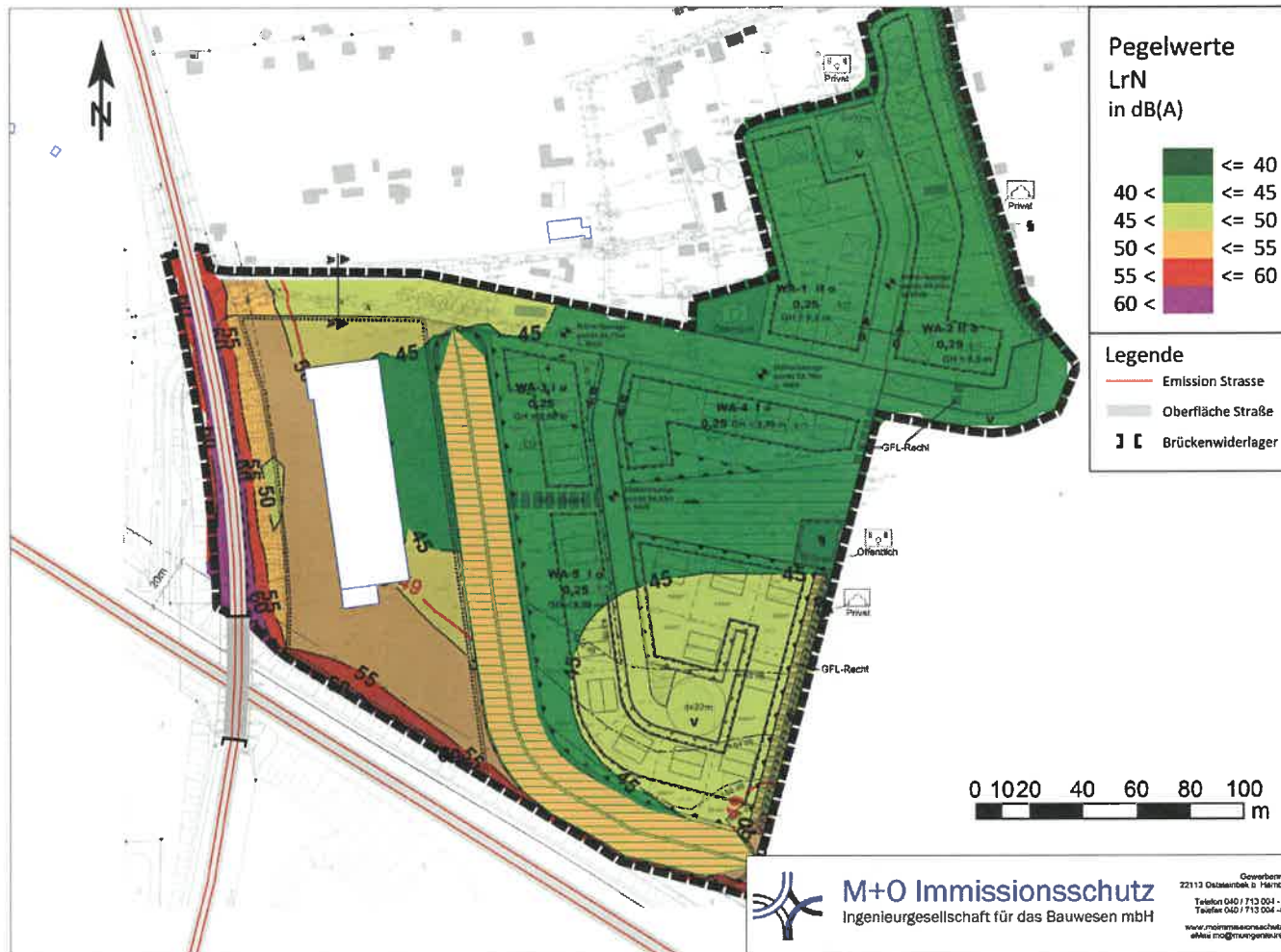
Abbildung 7: Immissionen aus Straßenverkehr (2,0 m über Gelände) nachts
