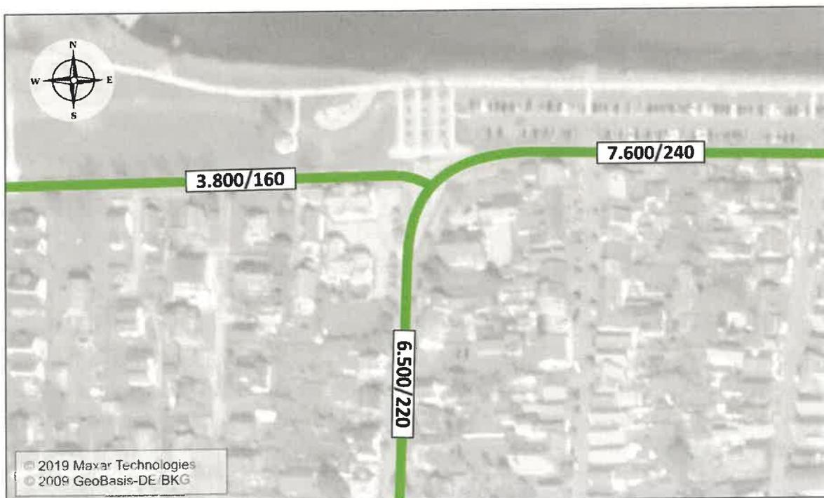
Bild 2-3: Analyse 2019 – DTV, DTV<sub>sv</sub>
