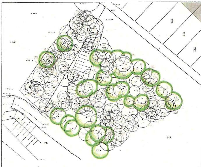
Abb. 6: Aufmaß des Baumbestands mit Kennzeichnung aller Bäume mit einem Stammumfang von mehr als 0,75 m (**vorrangig zu erhalten**)
