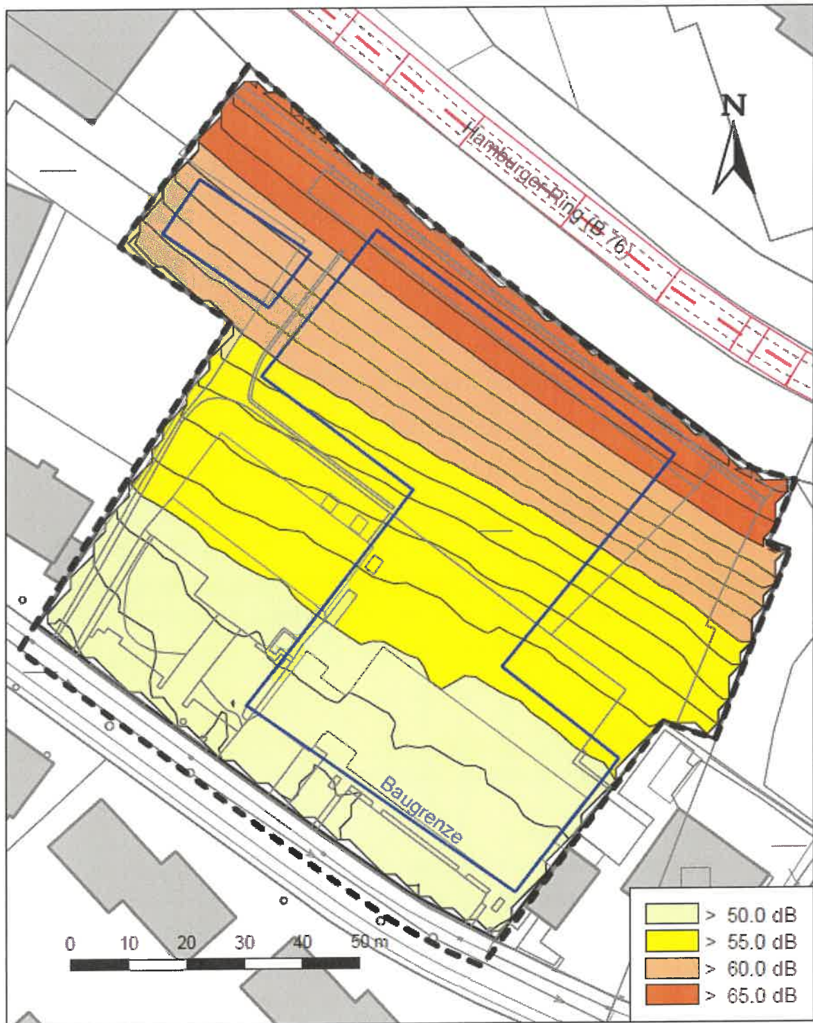
Abb.: Maßgeblicher Außenlärmpegel für schutzbedürftige Räume.
