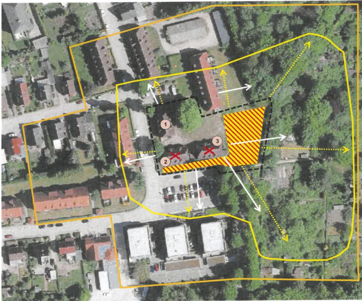
Abb. 3: Betrachtungsraum und Wirkräume der zu erwartenden Wirkfaktoren (Lärm und optische Einflüsse während der Bauphase, Betriebsphase, Pfeillänge (max. 50 m) entspricht dem Wirkungsbereich).
