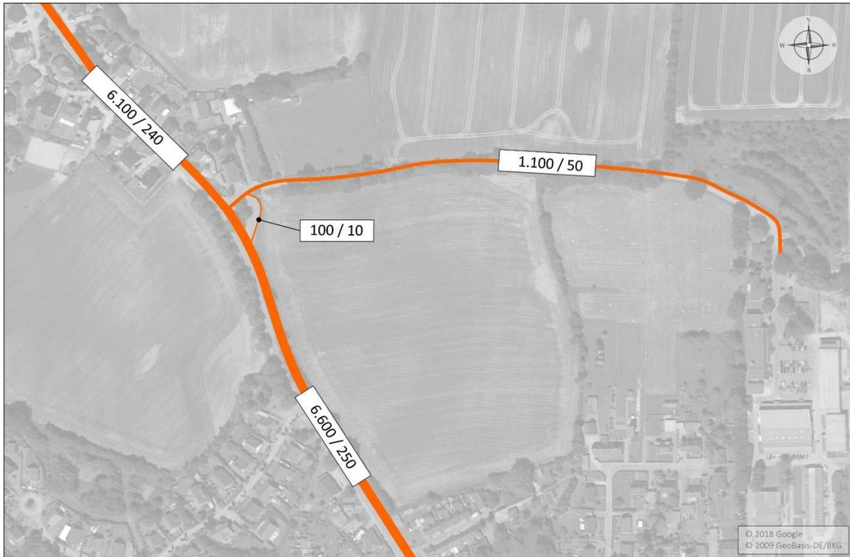
Bild 3-4: DTV, DTV<sub>SV</sub> - Prognose-Planfall 2030
