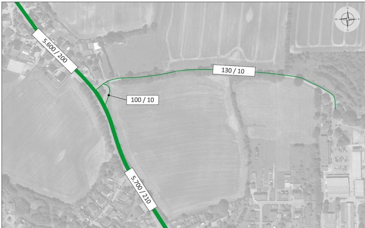
Bild 2-2: DTV, DTV<sub>SV</sub> - Analyse 2020
