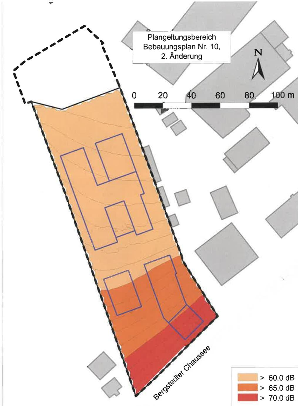
Abbildung 3: bei freier Schallausbreitung, Bereiche im Plangeltungsbereich, in denen die Immissionsrichtwerte überschritten wird, Maßstab 1:1.500
