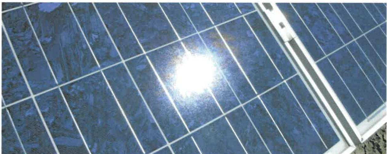
Bild 3.2.2: Diffuse Reflexion von direkten Sonnenlicht (Einstrahlung ca. 980 W/m<sup>2</sup>) auf einem PV Modul (Quelle: SolPEG)
