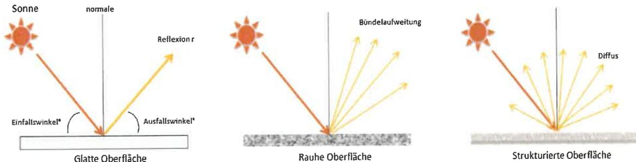
Bild 3.2.4: Reflexion von unterschiedlichen Oberflächen (Quelle: SolPEG)
