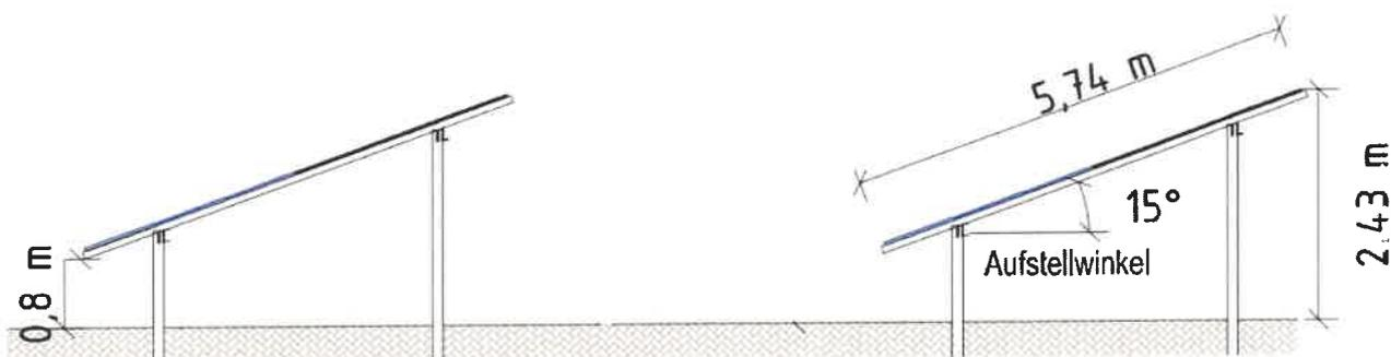
Bild 3.3.1: Skizzen der Modulkonstruktion (Quelle: Systemplanung, Auftraggeber)
