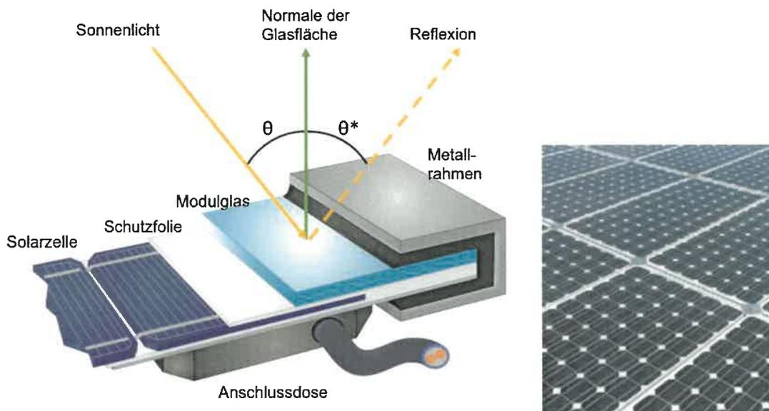
Abbildung 2: Aufbau eines PV-Moduls und Darstellung des Reflexionsgesetzes „Einfallswinkel = Ausfallswinkel“
